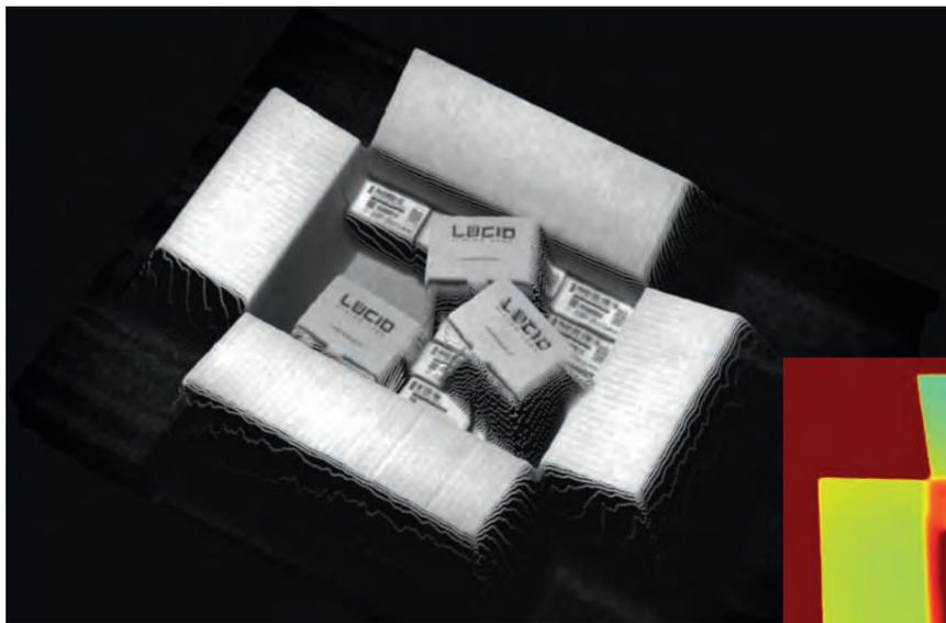
Bild 1 | Der neue DepthSense-Sensor IMX556PLR von Sony bietet eine Auflösung von 640x480 Pixeln. Live werden bis zu 60fps erfasst. Der Sensor ist in der Helios ToF-3D-Kamera von Lucid integriert, die in drei Arbeitsabständen betrieben werden kann.
