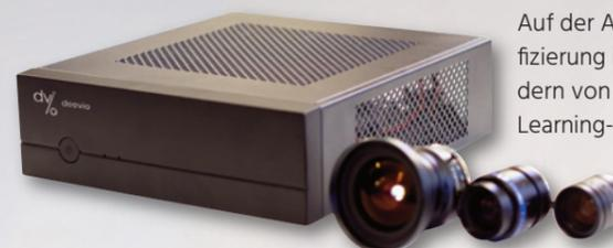
Auf der AI-Box von Deevio sind verschiedene Deep-Learning-Modelle zur Bildklassifizierung installiert. Ausgehend von knapp 100 Bildern von fehlerfreien sowie 100 Bildern von defekten Produkten generiert die Software automatisch das beste Deep-Learning-Modell, mit dem das Produkt dann geprüft wird. Die automatische Generierung der Modelle unterscheidet die Box von Wettbewerbsprodukten.
