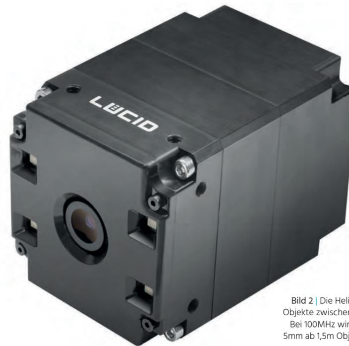
Bild 2 | Die Helios ToF-Kamera erkennt Objekte zwischen 0,3 bis 6m zuverlässig. Bei 100MHz wird eine Genauigkeit von 5mm ab 1,5m Objektentfernung erreicht.
