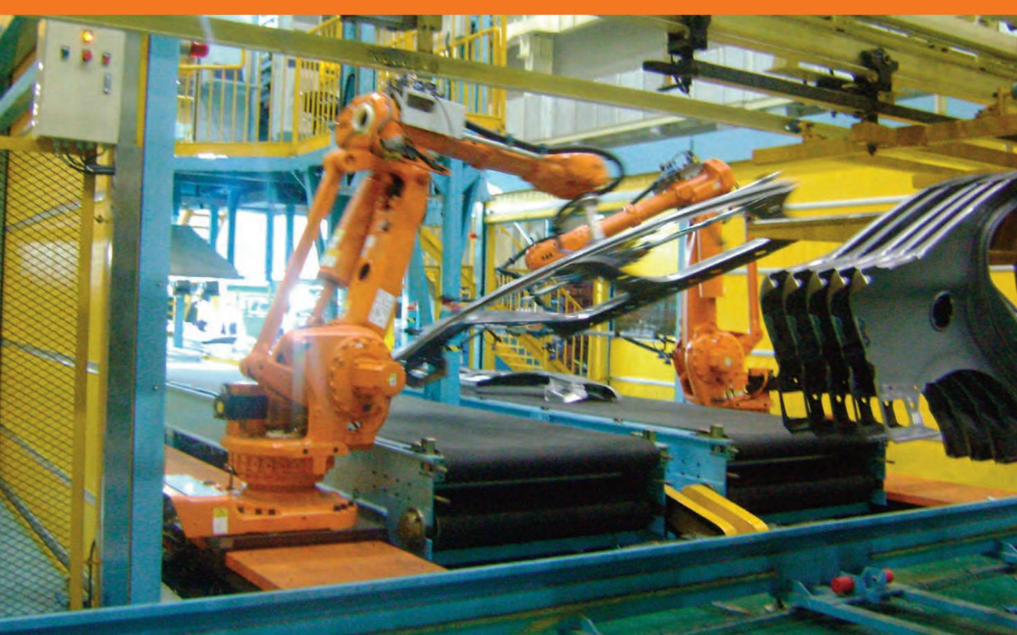
Bild 1 | Ein aus Teledyne-Dalsa-Bildverarbeitungssystemen und ABB-Robotern bestehendes Robotergreifsystem entnimmt Fahrzeugteile automatisch von einem Fließband und führt diese dem weiteren Produktionsprozess zu.
