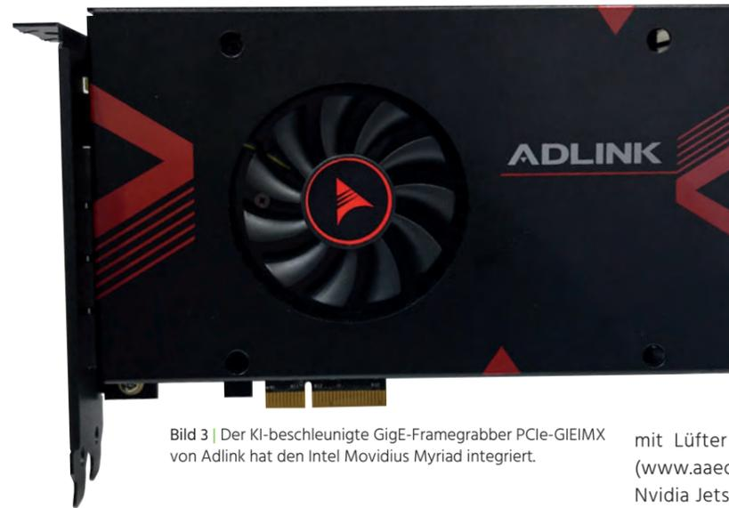
Bild 3 | Der KI-beschleunigte GigE-Framegrabber PCIe-GIEIMX von Adlink hat den Intel Movidius Myriad integriert.
