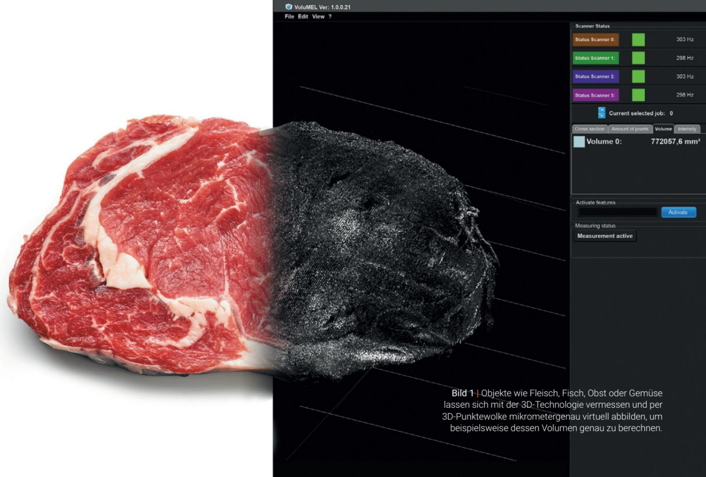
**Bild 1** | Objekte wie Fleisch, Fisch, Obst oder Gemüse lassen sich mit der 3D-Technologie vermessen und per 3D-Punktwolke mikrometergenau virtuell abbilden, um beispielsweise dessen Volumen genau zu berechnen.
