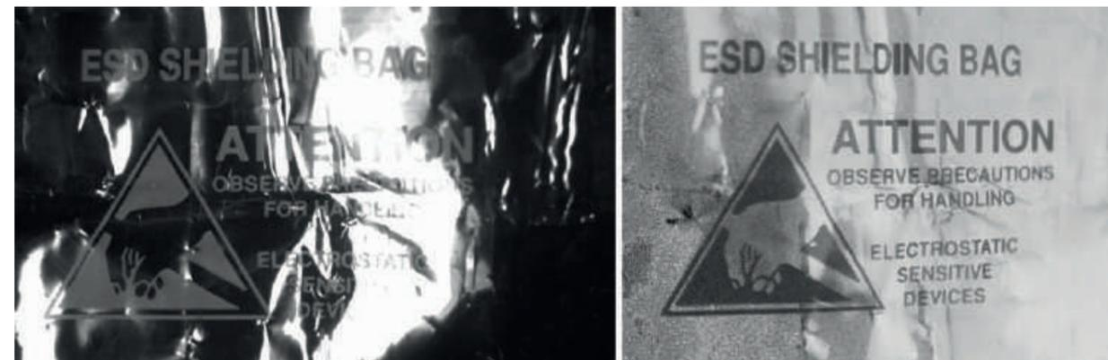
Bild 2 | In der Qualitätsprüfung spiegelnder Oberflächen wie Folie punkten Polarisationskameras und entfernen Glanzeffekte.
