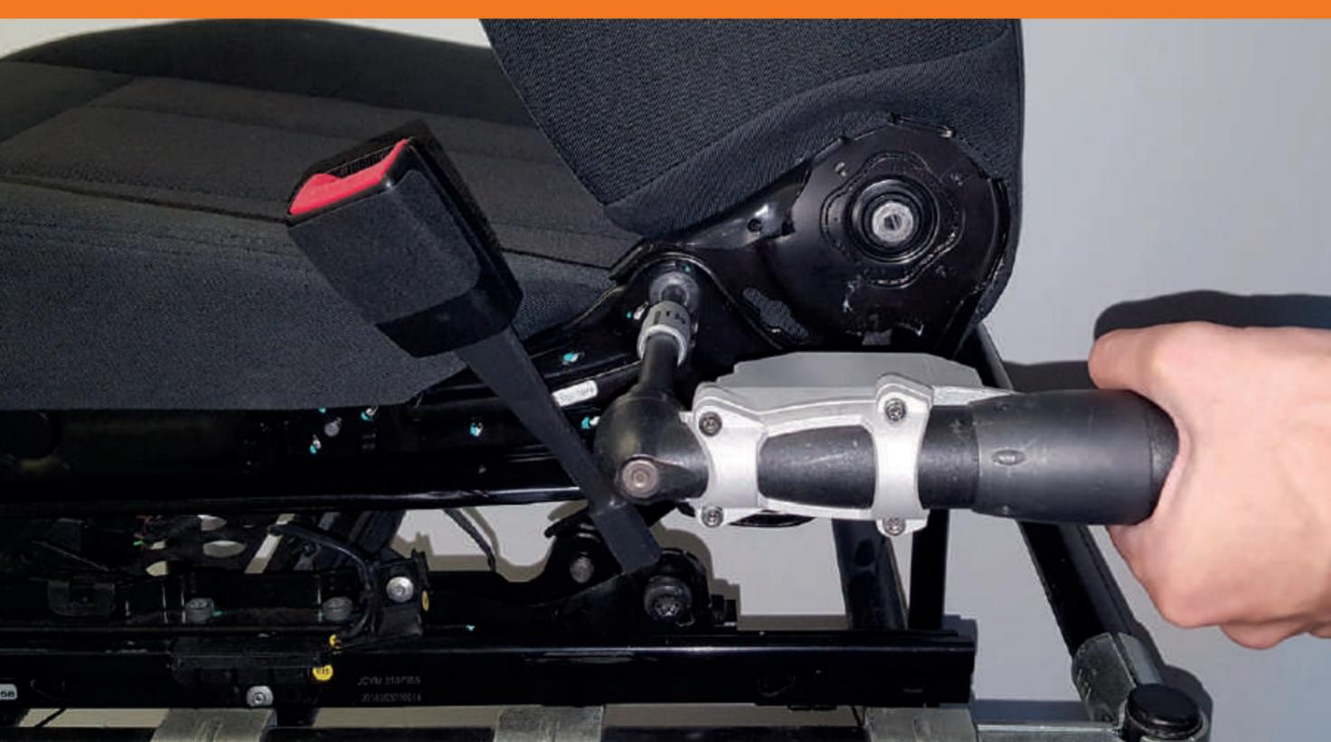
**Bild 1** | Das kamerabasierte Montagesystem Verpose ermöglicht eine ortsgenaue Erfassung bei der Montage von Schrauben oder Nieten. Durch die Bewertung der Aufnahmen erkennt es, welche Montagestelle soeben angefahren wird.
