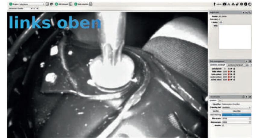
**Bild 2** | Die Bildschirmansicht: Die Software erkennt den Schraubpunkt und übergibt die Bewertung per API an das Montagemanagementsystem.
