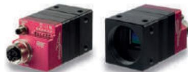
Die Positionsaarten werden als Statusinformation synchron mit den Bildern ausgegeben. Die A/B-Output können direkt an der Kamera angeschlossen werden und entsprechende Input Trigger werden in der Kamera generiert. Die Kamera ist prädestiniert für Lasertriangulationsanwendungen.
