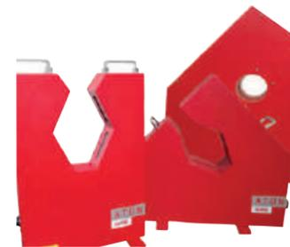
Das Profilmesssystem Aton Wire ist anwendbar bei Langprodukten mit rundem Querschnitt wie Drähten, Stabstahl und Rohren. Es hat eine Genauigkeit von 5µm und der Messbereich liegt zwischen 1 und 50mm Durchmesser. Je nach Temperatur des Materials, ist das System in drei Produktvari-
