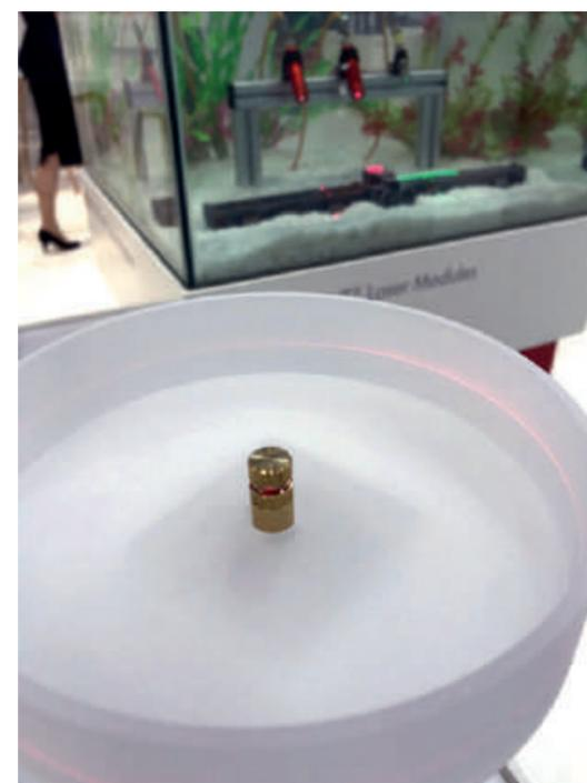
**Bild 2** | Das 360°-Linienlasermodul von Laser Components ermöglicht eine ringförmige Linie mit konstanten optischen Eigenschaften.
