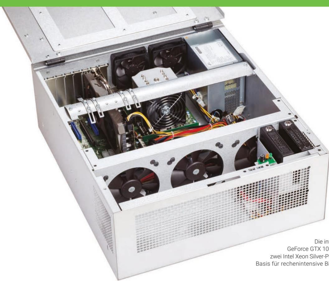
Die integrierte Nvidia-Grafikkarte GeForce GTX 1070 mit 8GB, kombiniert mit zwei Intel Xeon Silver-Prozessoren der CPU, ist die Basis für rechenintensive Bildverarbeitungsprozesse.
