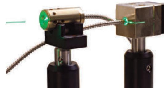
Der Linienlaser ilumFiber Vision mit homogenem Strahlprofil wird als kundenspezifische Lösung angeboten. Erhältlich sind unterschiedliche Strahlwinkel, Wellenlängen, Ausgangsleistungen und Strahlparametereinstellungen. Durch die Trennung von Laser und Optik mittels einer Singlemodefaser kann der Laser auch dort eingesetzt werden, wo aus Umweltbedingungen der direkte Einsatz von Laserdioden nicht möglich ist. Auf eine aufwendige Kühlung des Lasers kann deshalb verzichtet werden.
