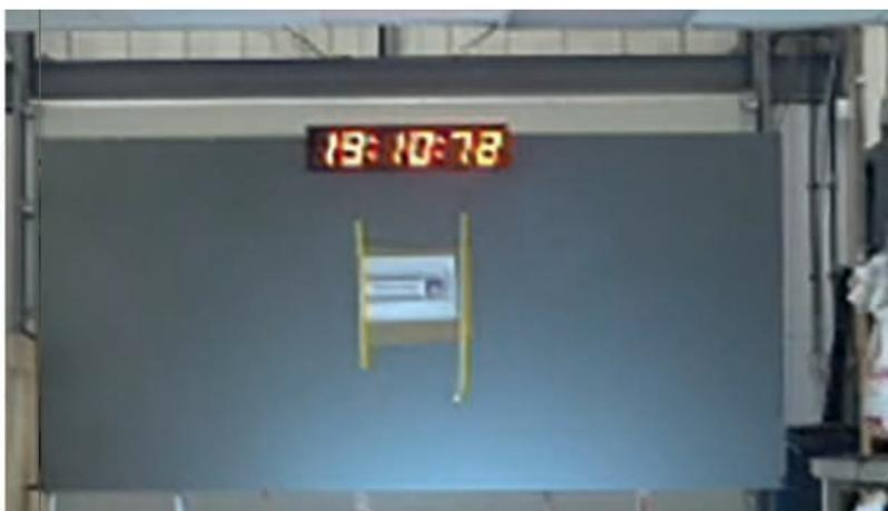
Die benetzte Kamera a) vor der Aktivierung der Ultraschallwandler, b) während der Ultraschallreinigung und c) die Kameraoptik in Sekunden gereinigt und von Flüssigkeitstropfen befreit.
