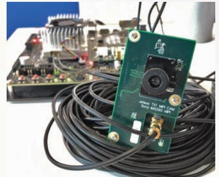
Bisher ging man bei MIPI/CSI-2 Modulen von lediglich 30cm Kabellänge aus. Die neuen MIPI/CSI-2-Kameramodule von The Imaging Source ermöglichen aber dank FPD-Link III Bridge Kabellängen von bis zu 15m bei gleichzeitiger Datenübertragung, Steuerkanäle und Stromversorgung über ein einziges Koaxialkabel. Systemlösungen auf Basis von Embedded Plattformen, wie z.B. Nvidia Jetson TX2, sind bereits vorhanden.
