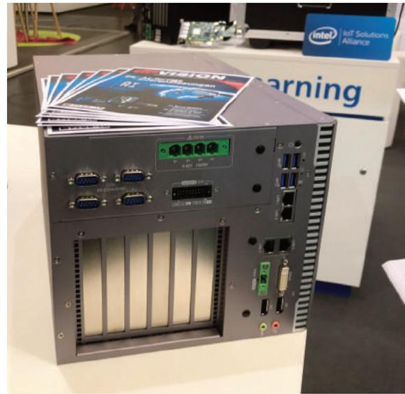
**Bild 2 |** Das Dual-GPU-AI-Computing-System GPC-1000 von Vecow ist mit zwei GPUs ausgestattet und bietet eine Leistungssteigerung von 37% gegenüber Kaby Lake-IPCs.
