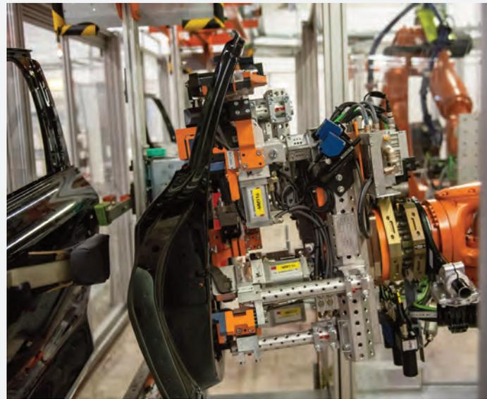
Bild 2 | Kontrollierte Türentnahme durch den Roboter
