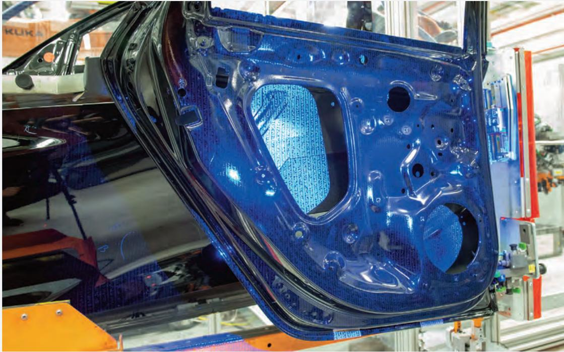
Bild 1 | Projiziertes Pattern zur 3D-Erfassung der Bauteilgeometrie
