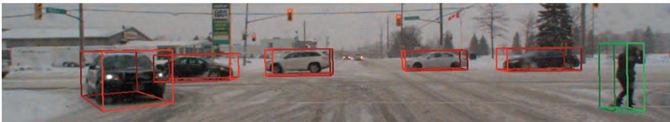
**Bild 2** | Die Machine-Learning-Algorithmen müssen auch bei schlechten Witterungsbedingungen und Kontrasten zuverlässige Ergebnisse liefern.
