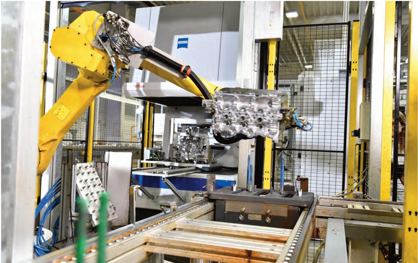
Bild 2 | Die Inline-Messtation von Zeiss ist komplett automatisiert: Ein Roboterarm greift die ankommende Zylinderkopfhaube.
