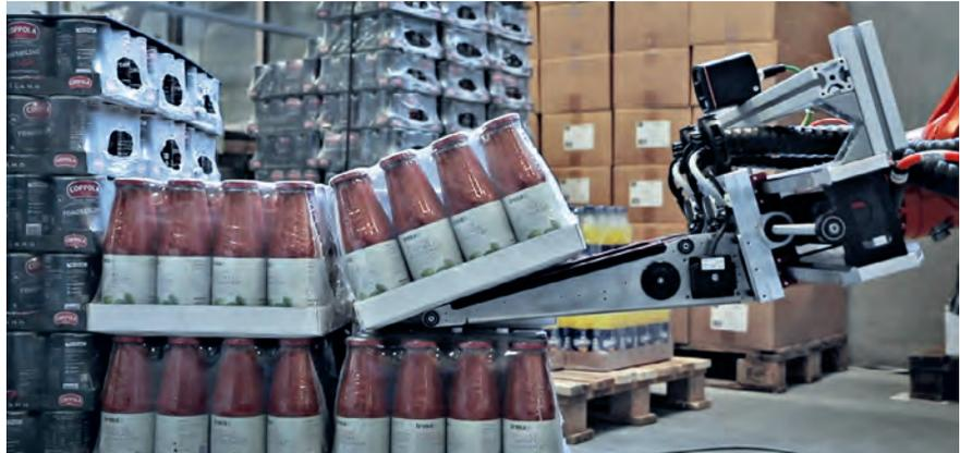
**Bild 2** | Mit dem PDS-System ausgerüstete autonome Stapler fahren bis auf eine Entfernung zwischen 1 und 2m an die zu greifende Palette heran, bevor eine ToF-Kamera eine 3D-Aufnahme der Palette erstellt.
