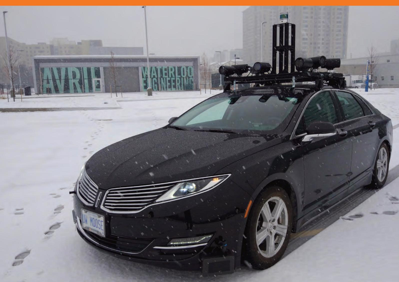
Bild 1 | Der Lincoln-MKZ-Hybrid mit seiner vollständigen Sensorausstattung durchstreift die verschneiten Straßen von Ontario und zeichnet Schlechtwetterdaten auf, um fahrerlose Fahrzeuge zu befähigen, diese Bedingungen schließlich zu meistern.
